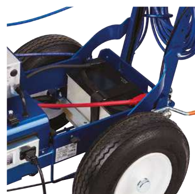
Compartiment de la batterie
